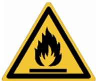
Wenn das folgende Symbol nach ISO 7010 W021 "Vorsicht; Brandgefahr/brennbare Materialien" im Kondensatorraum des Geräts vorhanden ist, müssen alle in IEC EN 60335-2-89:2011; IEC EN 60335-2-89/A1:2019-06; IEC EN 60335-2-89/A2:2020-01 definierten Anforderungen beachtet und eingehalten werden
